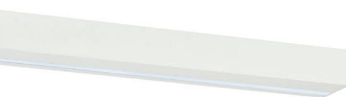
Apparecchio per applicazione a parete con sorgente a LED biemissione. Corpo in alluminio primario con verniciatura poliestere ad alta resistenza e trattamento superficiale protettivo. Diffusore in metacrilato satinato opalino antiurto. Staffe e viteria inox. Alimentatore elettronico resinato incluso.
