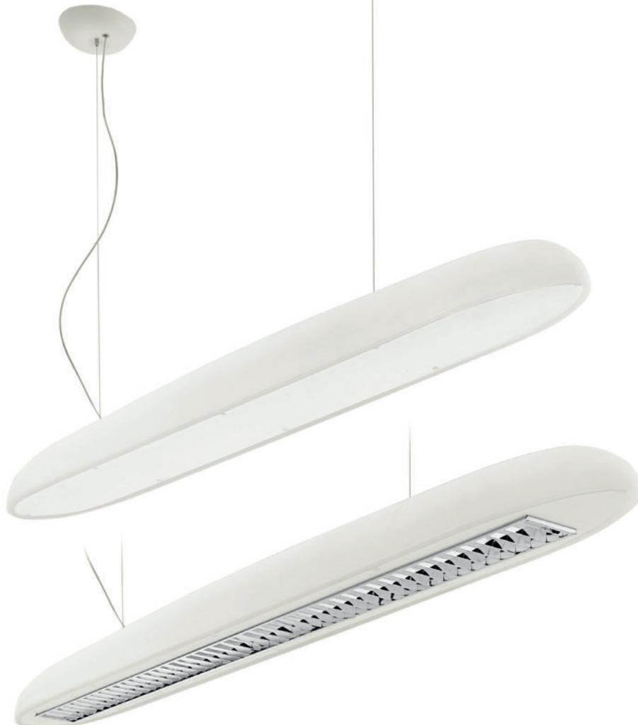
Apparecchio per applicazione a sospensione per sorgenti fluorescenti lineari T16. Corpo in polietilene naturale per un'emissione di luce diffusa o laccato nero semi-opaco con flusso luminoso esclusivamente sotto l'apparecchio. Diffusore in PMMA microprismatico o con ottica lamellare integrata in un diffusore PMMA opalino.
