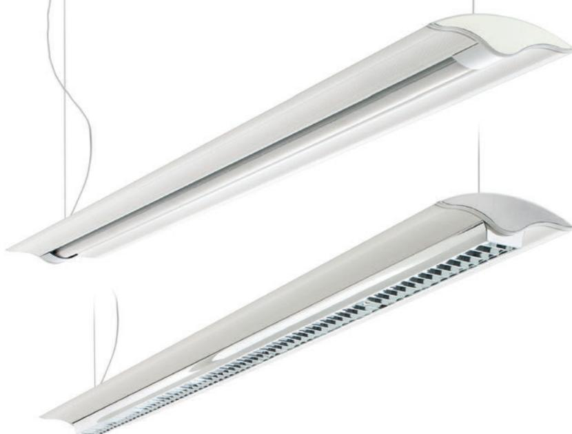
Apparecchio per applicazione a sospensione, esclusivamente per tubo LED a doppia emissione con alimentatore interno. Corpo in estruso di alluminio anodizzato o verniciato completo di tappi di chiusura, sospensioni e alimentazione. Versioni con sorgente a vista o con diffusore dark light in alluminio purissimo per il controllo della luminanza.
