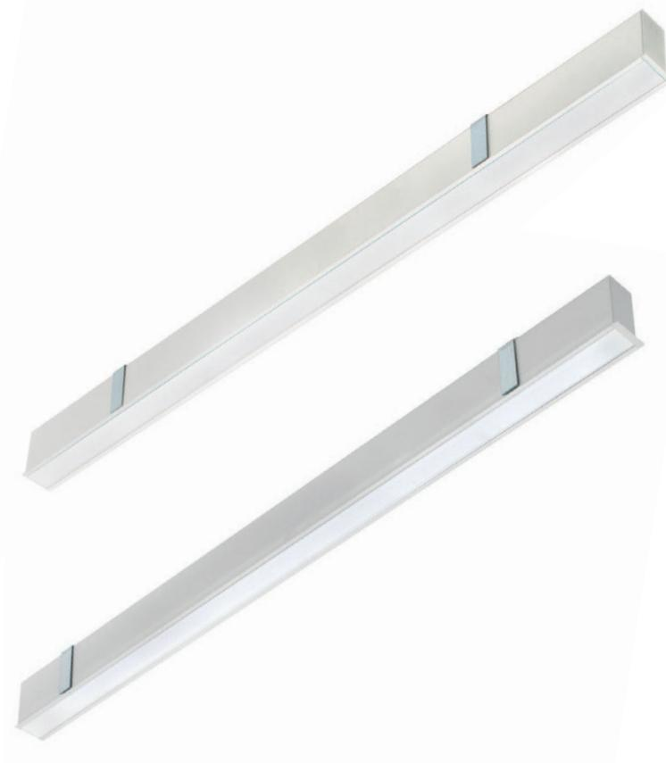
Apparecchio da incasso applicabile su contropareti e controsoffitti. Profilo in estrusione di alluminio verniciato o anodizzato. Utilizzo di elettrificazioni fluorescenti lineari T16 o a LED SMD ad alta efficienza. Diffusori in policarbonato opalino. Alimentatori inclusi.
