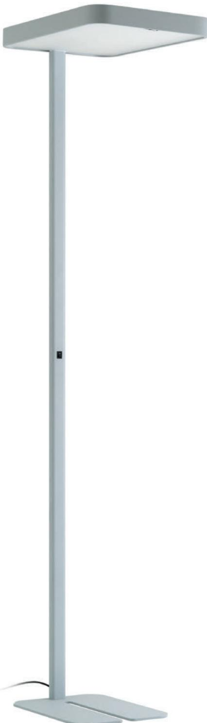
Lampada da terra con sorgente fluorescente biemissione. Corpo in estruso di alluminio sagomato e verniciato. Struttura portante e basamento in acciaio verniciato. Versioni con pulsante ON/OFF e dimmerazione oppure autodimmerabili con sensore di presenza e rilevatore di luce ambiente. Diffusore in PMMA microprismatico e ottica interna per il controllo della luminanza.
